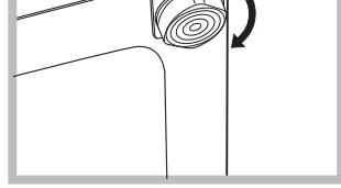
Належне вирівнювання надає стабільність машині та запобігає вібрації, шуму та пересуванню під час роботи. При встановленні машини на килимовому покрівлі або килимі відрегулюйте ніжки таким чином, щоб залишити під пральною машину достатній простір для вентиляції.
